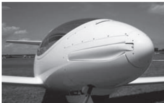
Chic und zweckmäßig: Der in die Rumpfform integrierte Faltpropeller
